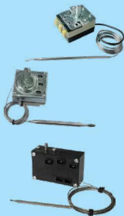
I termostati a capillare sono soggetti a deriva a causa delle variazioni di temperatura sul capillare e sul soffiutto. Il differenziale dei termostati a lampada e a capillare non è solitamente regolabile ed è pari a circa il 2.5% dell'intervallo di temperatura. Sono disponibili in versione unipolare o tripolare.
